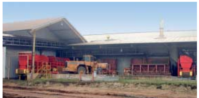
»1 Beschickungsanlage: Befüllung über Gurtförderer und Schaufellader »1 Box feeder plant: Charging via conveyor belts and front-end loader
