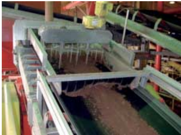
»3 Gurtförderer mit Materialverteiler (Synchroquirl) »3 Belt conveyor with material spreader ("Synchroquirl")
