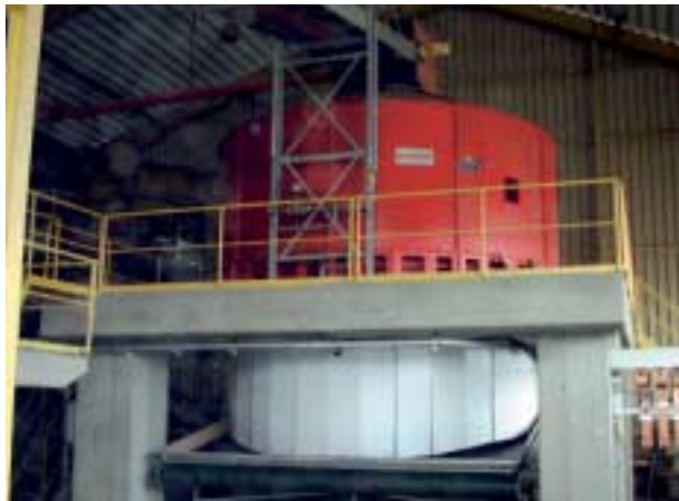
»2 Kollergang mit Auslaufhaube und Abzugsband »2 Wet pan mill with discharge chute and collecting belt
