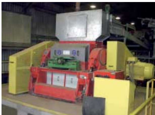
»4 Schwingenwalzwerk mit angebauter Walzendrehmaschine »4 Hinged-type fine roller mill with installed roller turning machine
