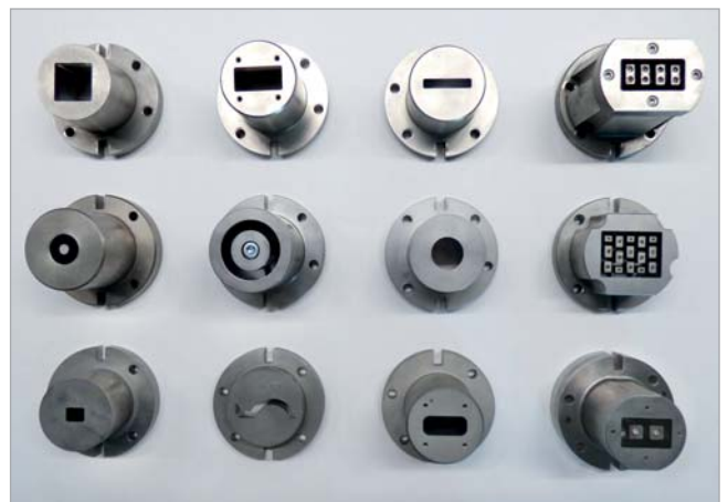
Unterschiedliche Labormundstücke für Extrusionstests
