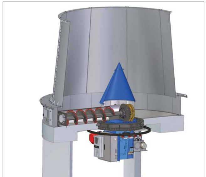
Querschnitt des Rundsilos mit Ausräumgerät bestehend aus: Drehkörper, Ausleger mit Frässhnecke und Lagerung, Schneckenantrieb, Vorschubantrieb
