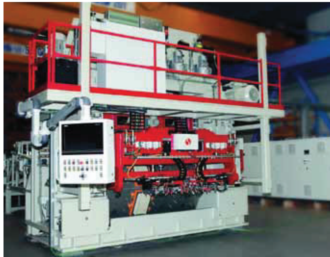
› The new Nova III roof tile press with eccentric cam › Die neue Exzenter-Dachziegelpressen Nova III
