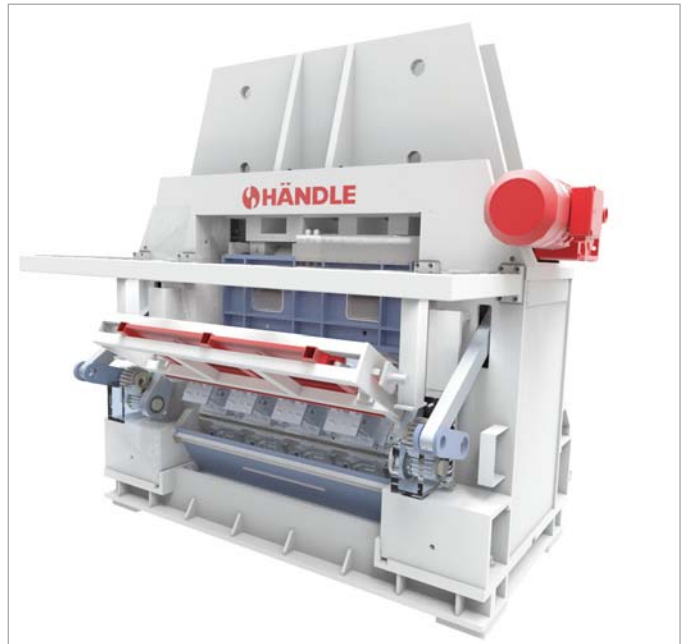
Zentraler Antrieb und mechanische Synchronisierung der Hauptbewegungen
