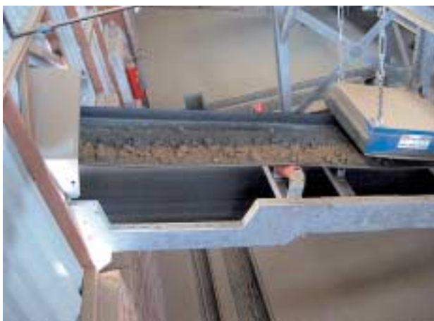
»6 Extracting magnet on the belt conveyor to the pan mill »6 Aushebemagnet auf dem Gurtförderer zum Kollergang
