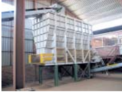
»5 Buffering and proportioning box feeder for the pre-crushed clay stone »5 Puffer- und Dosierkastenbeschicker für den vorgemahlene Tonstein
