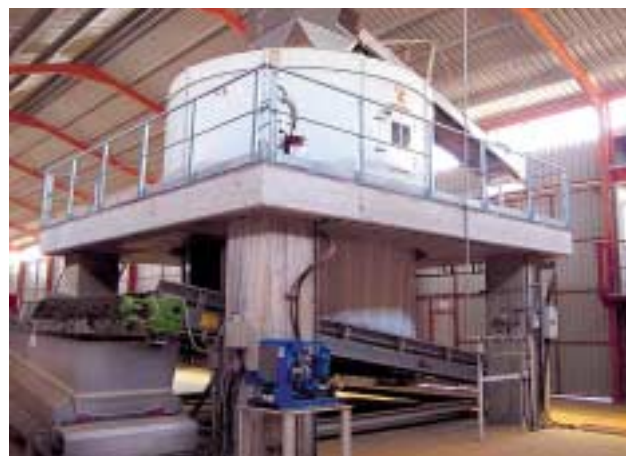
»7 Pan mill HMI 2170c with discharge hood and collecting conveyor »7 Kollergang HMI 2170c mit Auslaufhaube und Sammelförderer
