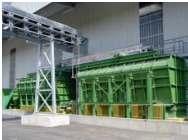
»5 Box feeder station in the factory: feeding by mobile and reversible belt conveyors and conveyor line from the pit »5 Beschickerstation im Werk: Befüllung über fahr- und reversierbare Gurtförderer und Bandstraße von der Grube
