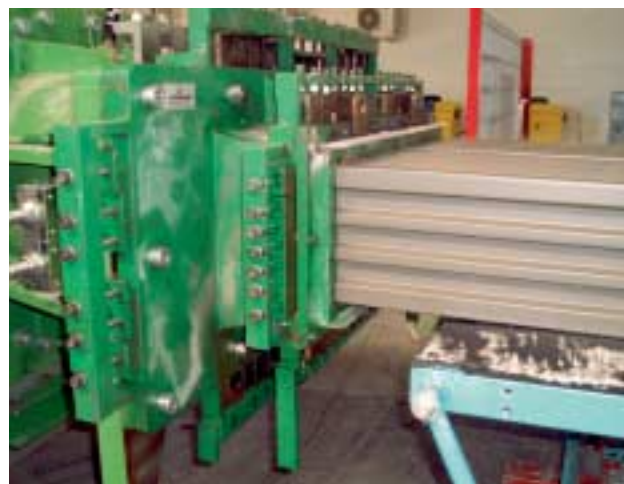
»14c Regulating die for twin-column exit »14c Reguliermündstück für zweisträngigen Austritt
