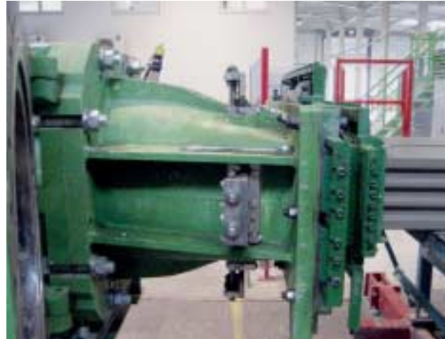
»14b Pressure head with regulating slides provided on four sides and with attached regulating die »14b Presskopf mit vierseitig angeordneten Regulatorschiebern und angebautem Reguliermündstück
