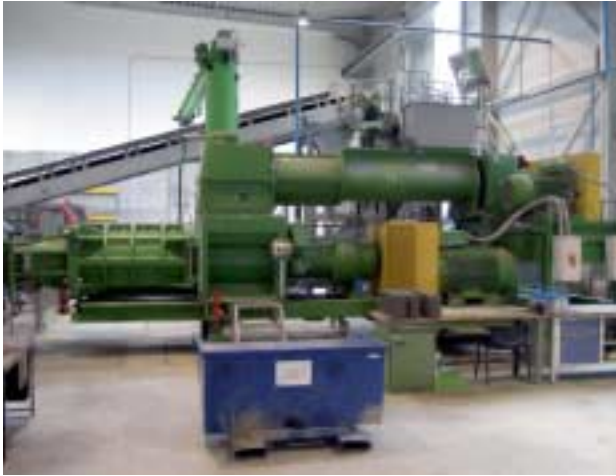
»14a Combined de-airing extrusion unit model EVMG 75a/70/1025f mounted on lifting and lowering mechanism »14a Vakuumaggregat Type EVMG 75a/70/1025f installiert auf Hub- und Senkvorrichtung
