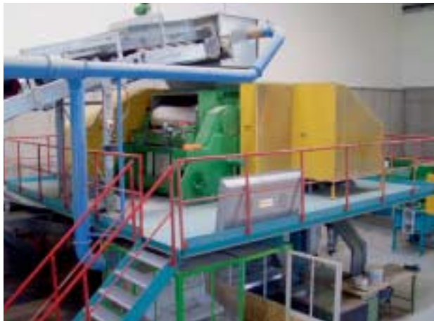
»8 Hinged-type fine roller mill Alpha II model WFZH 10150d with attached roller turning lathe model WDH 150 pa »8 Schwingenwalzwerk Alpha II Type WFZH 10150d mit angebaute Walzendrehmaschine Type WDH 150 pa
