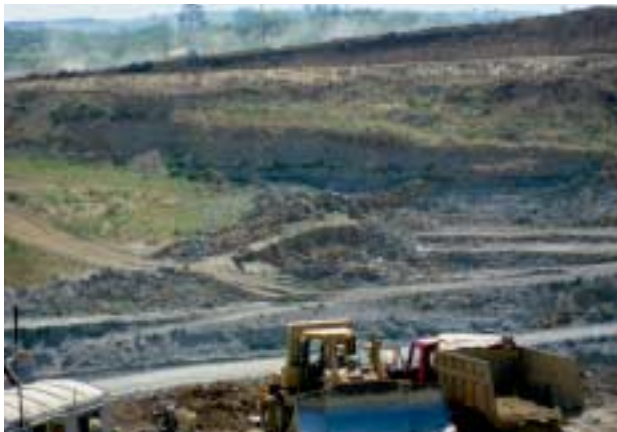
»2 View of the clay pit: top layer yellow clay, bottom layer grey clay »2 Blick in die Grube: obere Schicht gelber Ton, untere Schicht grauer Ton
