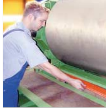
Abstreifer in Ausbaustellung
