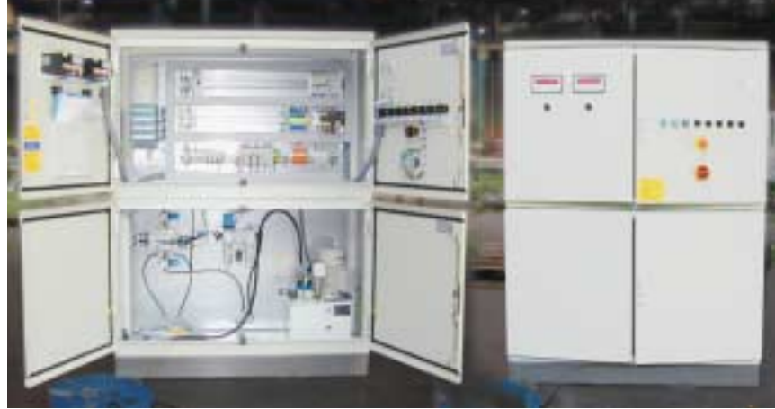
Schaltschrank mit sämtlichen Steuerelementen, Hydraulikaggregat und digitaler Walzenspaltanzeige
