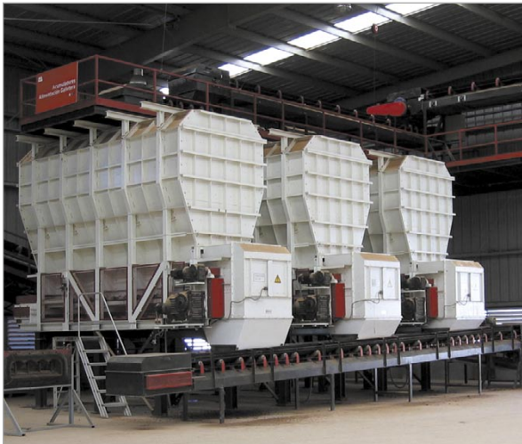
HÄNDLE Dosierkastenbesicker für Formgebungsanlage zur Herstellung von Dachziegeln.
