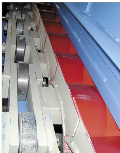
Schuppenband mit Rollenkette für Kastenbeschicker der Typen BKN und BKSS
