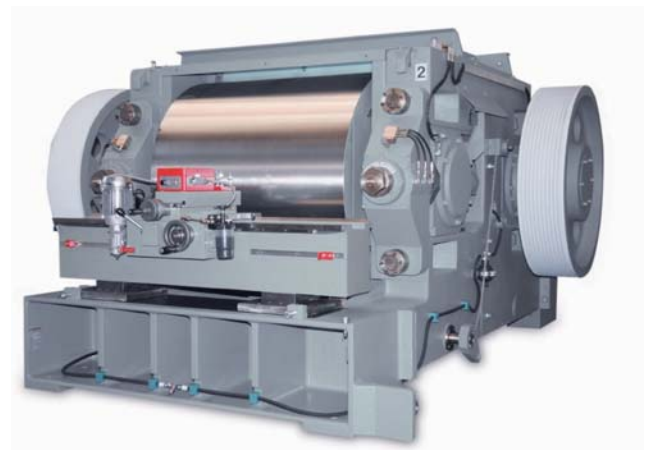
Walzwerk Type WF 10100e mit manueller Verstellereinrichtung
