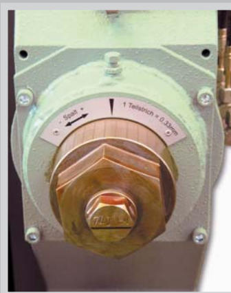
Walzwerk Type WF 10100e mit manueller Verstellereinrichtung
