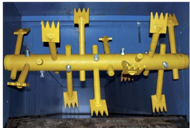
Haspelwelle mit gekröpften und gezackten Haspelmessern für krümeliges und aufbereitetes Material
