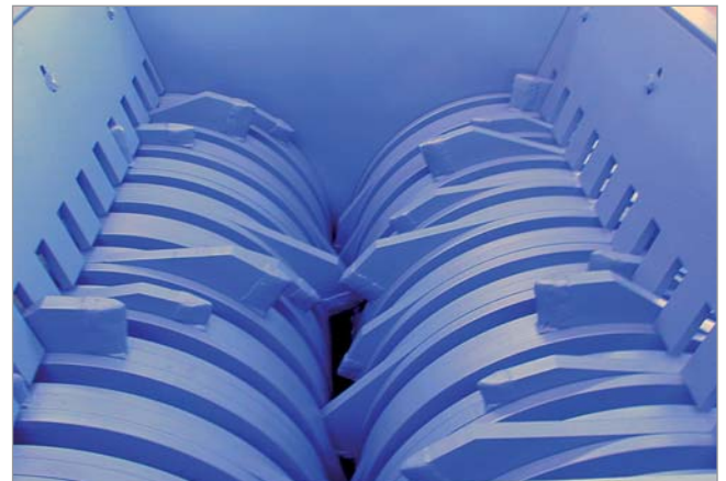
Messerscheiben eines Walzenbrechers Type WMH 818a
