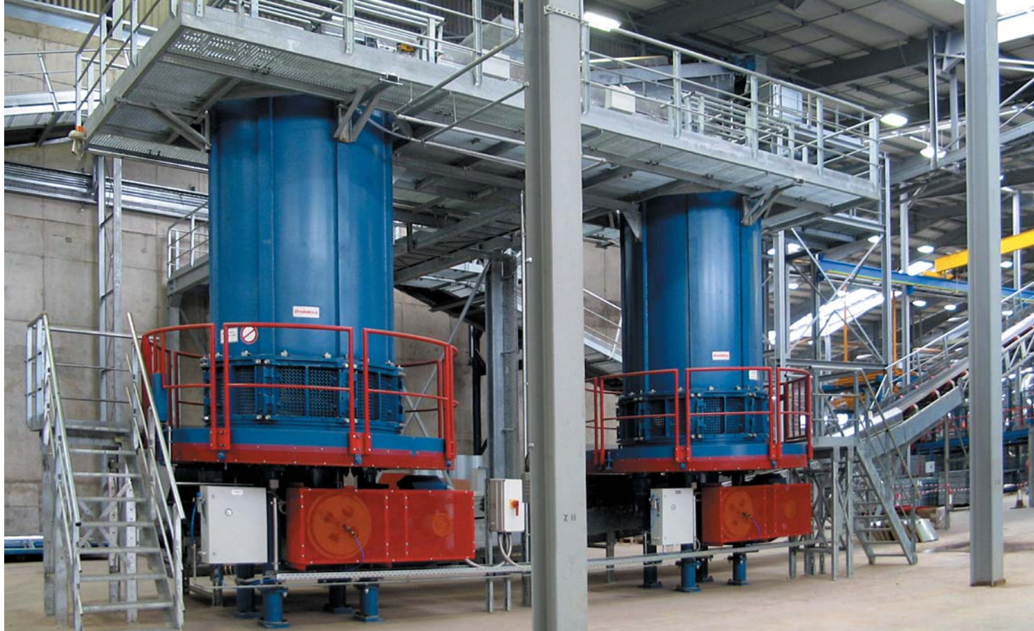
Zwei Siebrundbeschicker der Type BRSH 19c in einem Ziegelwerk in Großbritannien
