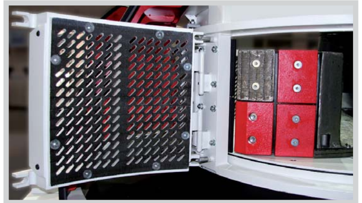
Siebe schwenkbar installiert für leichte Zugänglichkeit Verschleißbleche am Ausstreicharm
